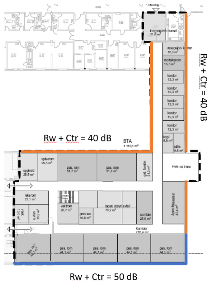
Figur 7. Oversikt krav til facade/vinduer
